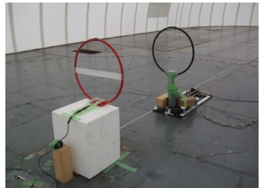
図A.5—離隔距離減衰確認実験写真
