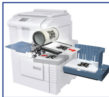
③裏面を印刷し、排紙台に両面印刷された用紙が積載されます
